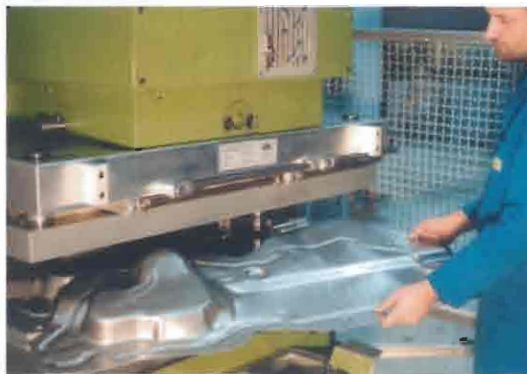
Formen ›ohne Ende‹: Die Qualität der Blechoberfläche und die Werkzeugstandzeit lassen sich mit einer Hartematal-Beschichtung zusätzlich steigern
